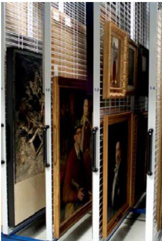
Panel rectangular sobre el que cuelgan las obras de arte provisto de doble malla construida con varilla electrosoldada de acero calibrado pre-galvanizado de 5 mm. de diámetro, según norma UNE 37-506. Las varillas verticales y horizontales forman huecos de 100 x 50 mm. La malla incorpora un marco perimetral en tubo de acero de 55 x 30 x 1,5 mm. con doble pestaña. En la parte frontal va provisto de un tirador de aluminio y visor porta-títulos.
