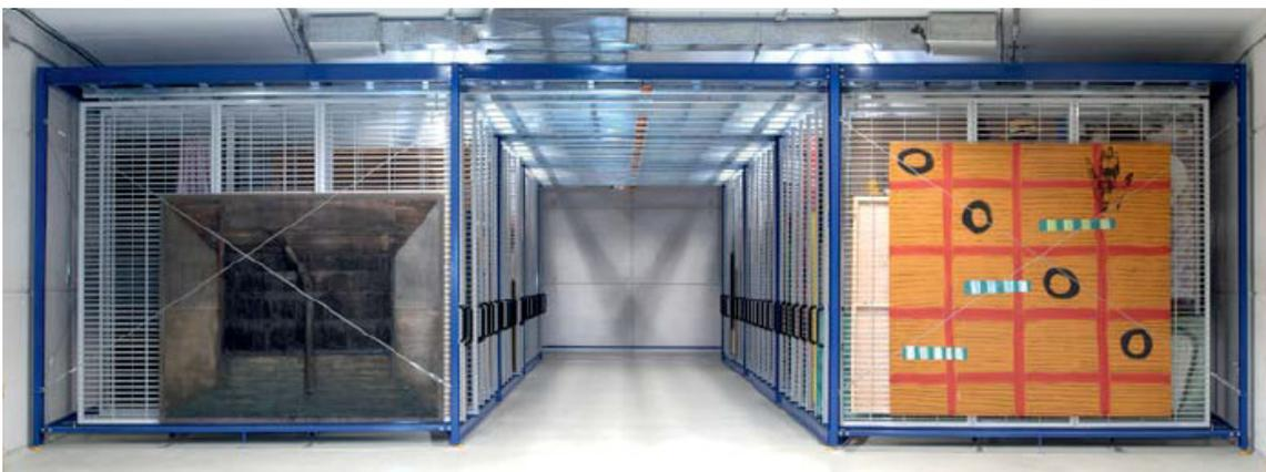
Mecanismo provisto de cuatro ruedas de acero bicromatado con rodamientos a bolas, regulables en altura. Cada peine cuelga de dos o más carros que se deslizan sobre la guía superior. La carga máxima admisible por cada carro de deslizamiento es de 1.800 Kg.
